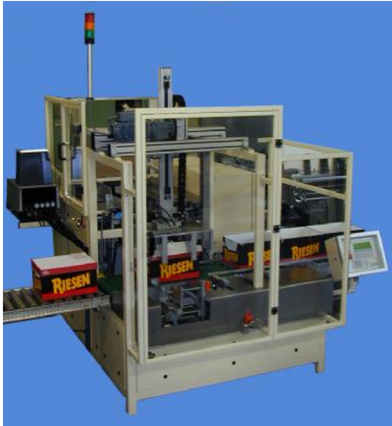
Zum automatischen Aufsetzen von Traydeckeln auf Trays oder FKH's
