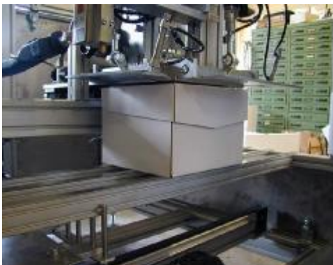
7. Fertiges Tray mit verklebtem Deckel
