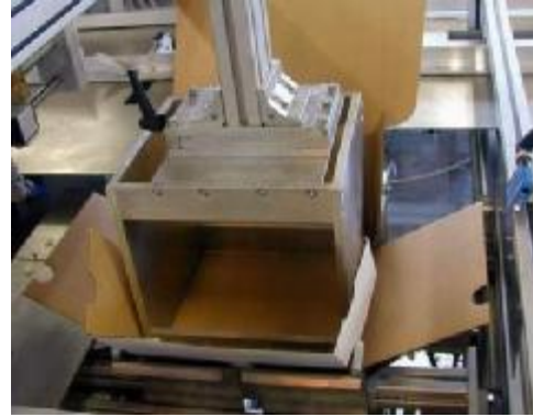
2. Aufrichten des Trays mittels Formstempel
