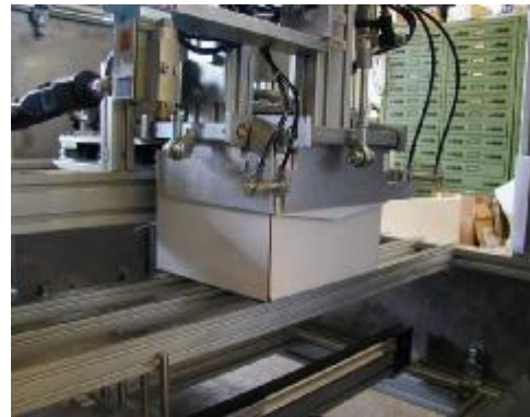
6. Tray mit angedrücktem Einfalt-Werkzeug
