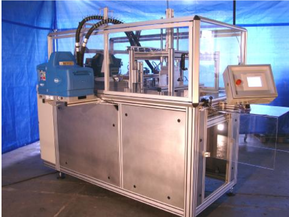
Zum automatischen Aufrichten und Verkleben von Wellpappetrays mit Heißleim
